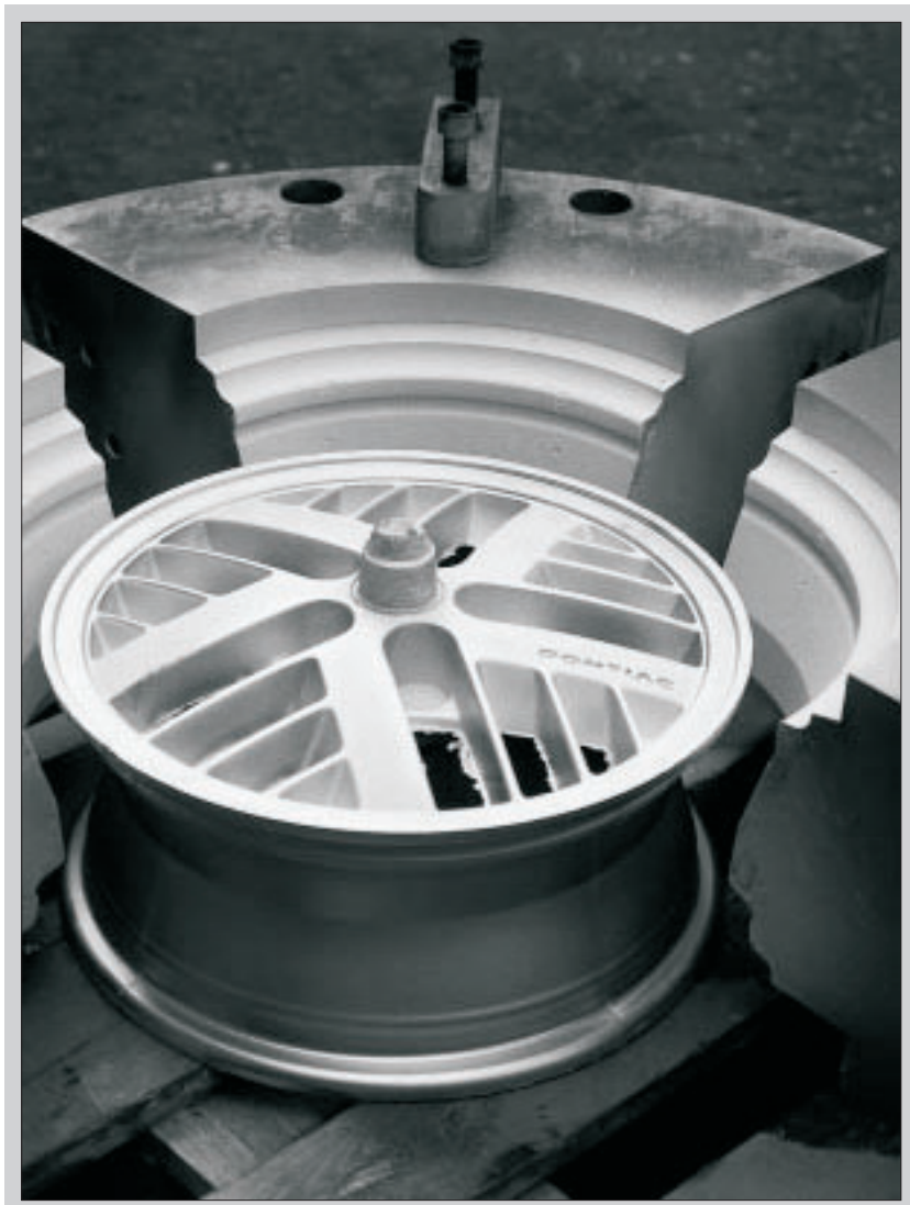
Zastosowanie środka antyadhezyjnego przy wyjmowaniu z form felg aluminiowych
