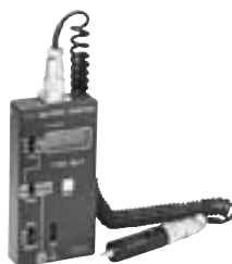
Przenośne urządzenie do monitorowania łożysk typu NB-4 (wykrywacz nieprawidłowości łożysk) (Kat. nr E410)
